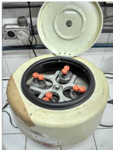
FIGURA 1 - CENTRIFUGAÇÃO PARA SEPARAÇÃO DO ÓLEO DA MO
