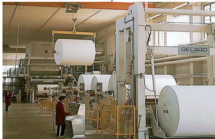
FIGURA 1 – ENROLADEIRA. FORMAÇÃO DO ROLO JUMBO. VISÃO GERAL
