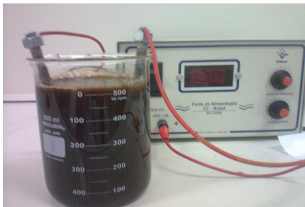
FIGURA 1 - ESTRUTURA PARA REALIZAR ELETROFLOCAÇÃO.
