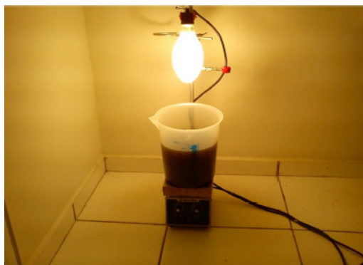
FIGURA 2 - REATOR FOTOCATALÍTICO MONTADO EM LABORATÓRIO.
