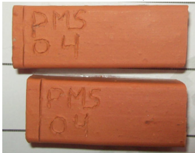
FIGURA 1 - AMOSTRA DOS CORPOS DE PROVA QUEIMADOS A 850 E 950°C.
