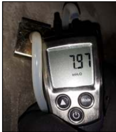
Figura 12: Pressão de ar quente saída do infravermelho
