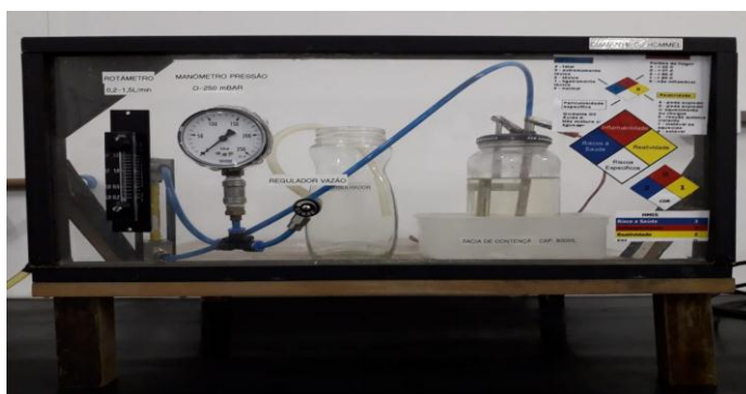
Figura 1-Módulo Experimental do Gerador de Hidrogênio
