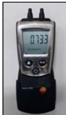
Figura 14: Medidor de pressão e temperatura
