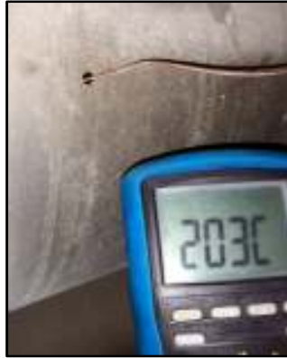
Figura 13: Temperatura saída do infravermelho
