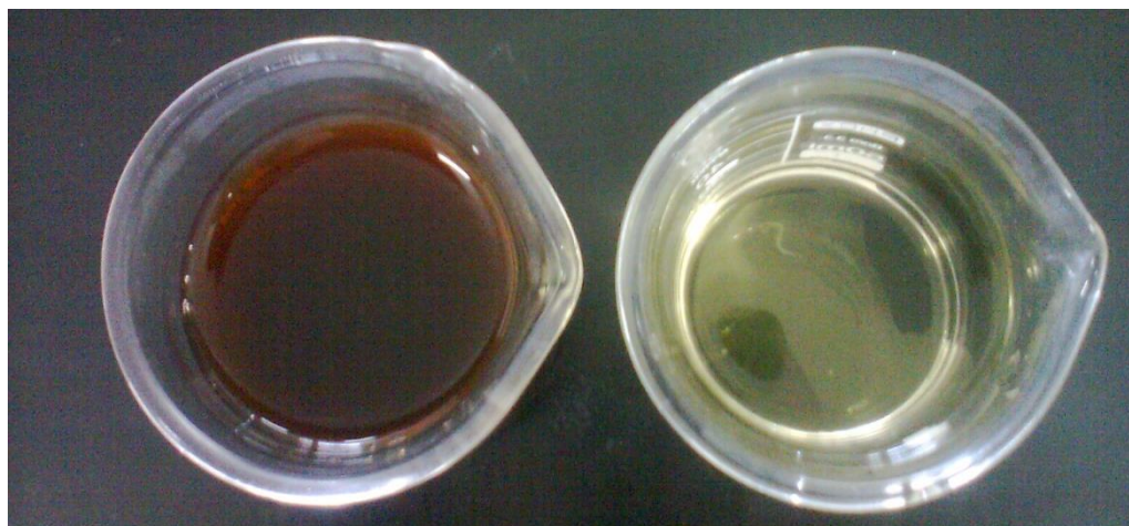
Figura 8 - Visualização da redução de coloração do efluente industrial antes e após tratamento
