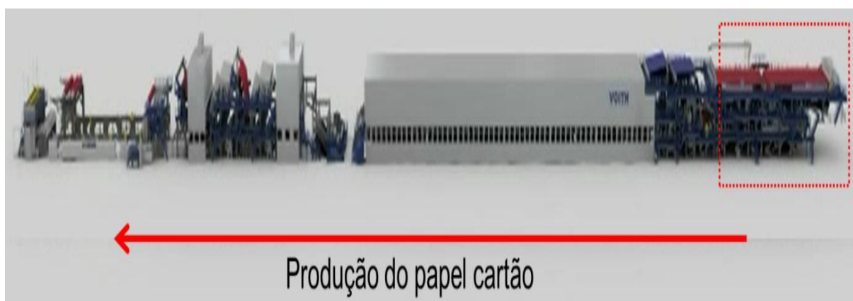
Figura 10 – Layout maquina de papel indicando a seção de formação.
