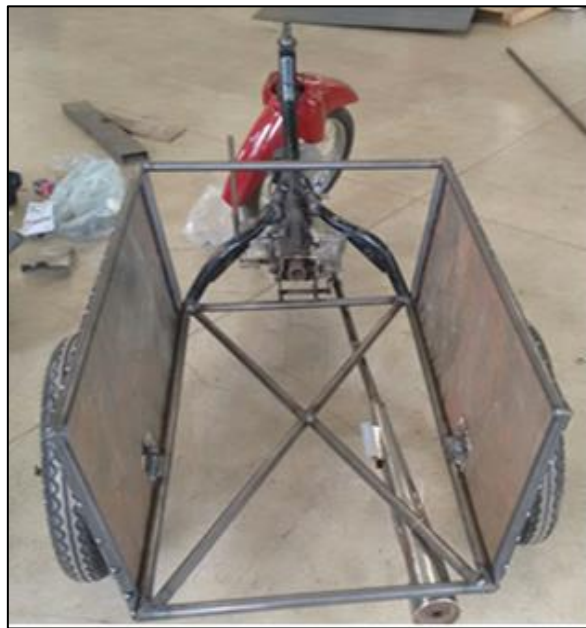
Figura 2 - Instalação de chapas laterais
