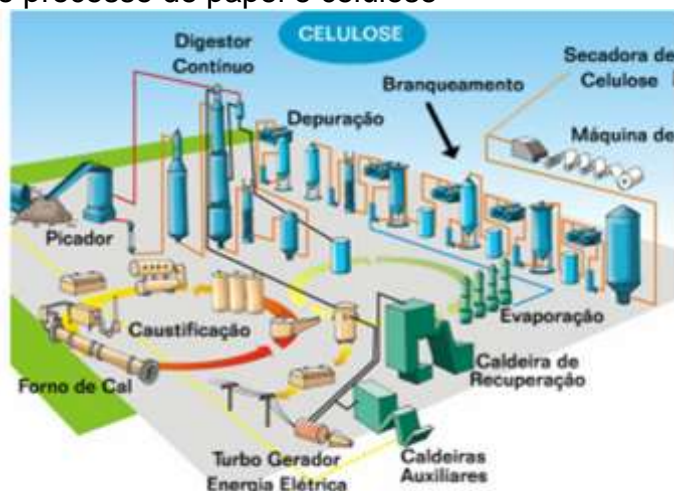
Figura 1: Ilustração do processo de papel e celulose
